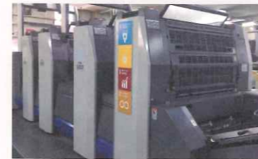
ランプにLEDを搭載したLED-UV印刷機。従来の印刷機と比べて消費電力が約80%少なく、オゾンが発生しない。(画像提供:大川印刷)
